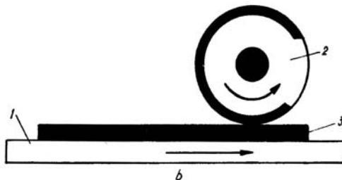
Litografia – variantă a tiparului plan.
