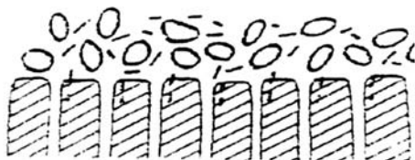
Reprezentarea fenomenului de filtrare în cazul hârtiei microporoase
