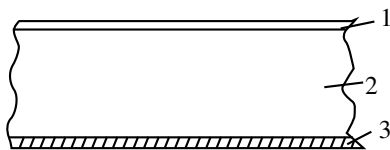
Placa de polimer cu suport de oțel 1 - folie de protecție; 2 - fotopolimer; 3 - placă de oțel
